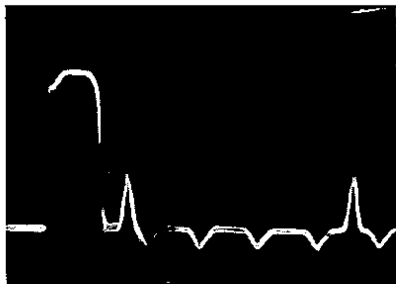
眼軸測定の模形図とブラウン管像
